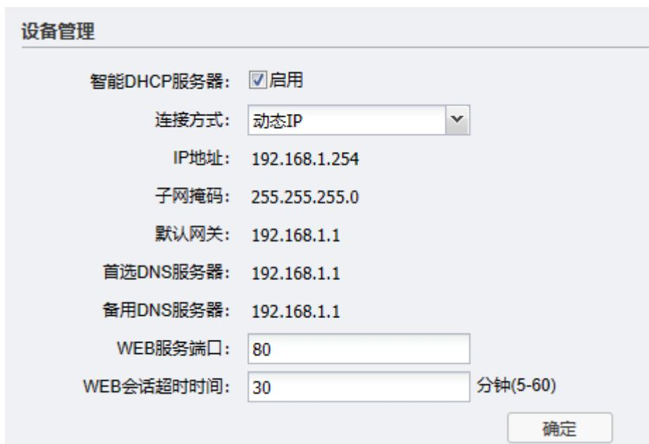
**智能 DHCP 服务器** 可启用 DHCP 服务器。DHCP 服务器能够自动给局域网中的设备分配 IP 地址。
