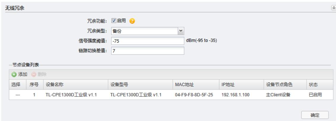
如上图所示，手动启用冗余功能，本设备会自动设备为主链路 Client（主 Client 设备），冗余类型选择“备份”（默认类型），点击<确定>使配置生效。
